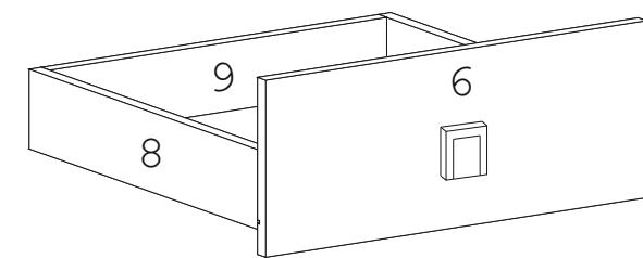
5. Соединить деталь 6 с деталями 7 и 8, затянуть эксцентрики А по часовой стрелке до упора.
