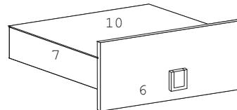
6. Вставить деталь 10 в паз на дет. 6 и выровнять относительно боковых и задней стенок ящика.
