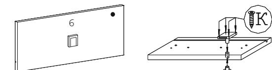
2. Привернуть ответную планку N на крышку тумбы напротив замка.
