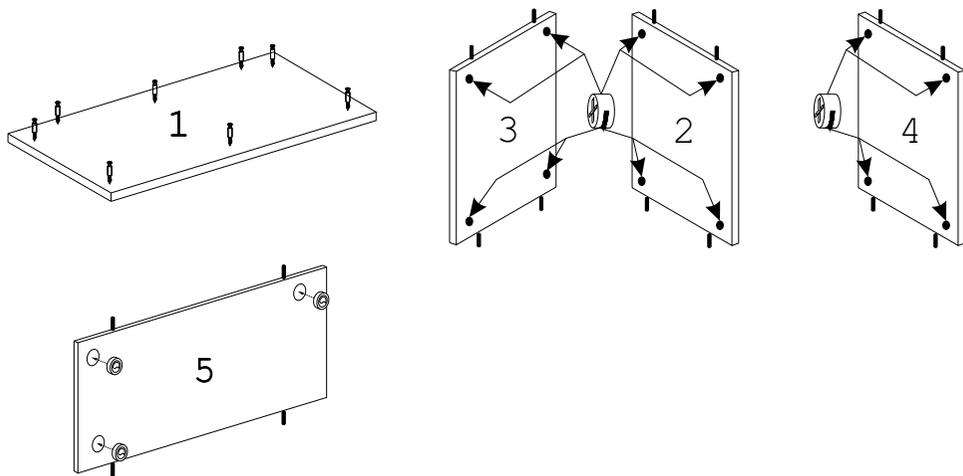
4. Вбить фурнитуру для навески D в отверстия на детали 5.
